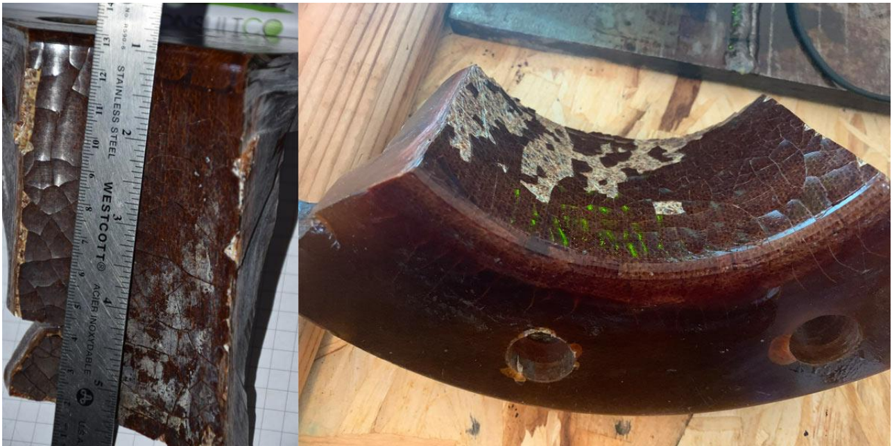
Figura 4. Condición y corrosión superficial interna del FRP
